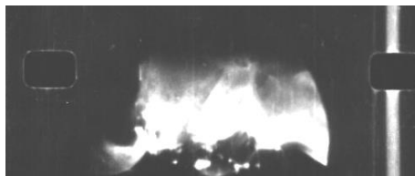
Рисунок 3.49 – Мікрокінокадри спалахування частинок металевого пального на поверхні горіння сумішей для різних співвідношень компонентів ( \varepsilon_n = 0,05 \dots 0,2 ; \varepsilon_{\phi} = 0,02 \dots 0,1 ; K_Y = 0,95 \dots 0,96 ; T_0 = 293 К; P = 10^5 Па): а) – знімки для 0,5 < \alpha < 1,0 (надлишок металевого пального); б) – знімки для \alpha = 1,0 (стехіометрична суміш); в) – знімки для 1,0 < \alpha < 3,0 (надлишок окиснювача).
