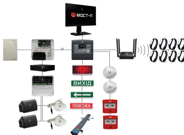
Рис. 6. Орієнтована структура системи пожежної сигналізації та оповіщення та управління евакуацією для людей з порушенням слуху.
