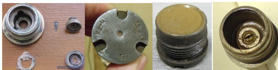
Рис. 1 – Капсульна втулка четвертого зразка КВ-4 (54-В-024): (діаметр різьби Ø 27 мм; 558 – завод-виробник; 50 – номер партії; 85 – рік виготовлення)
