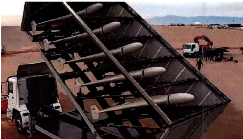
Рис. 1. Пускова установка БПЛА “Shahed-136” замаскована під самоскид
