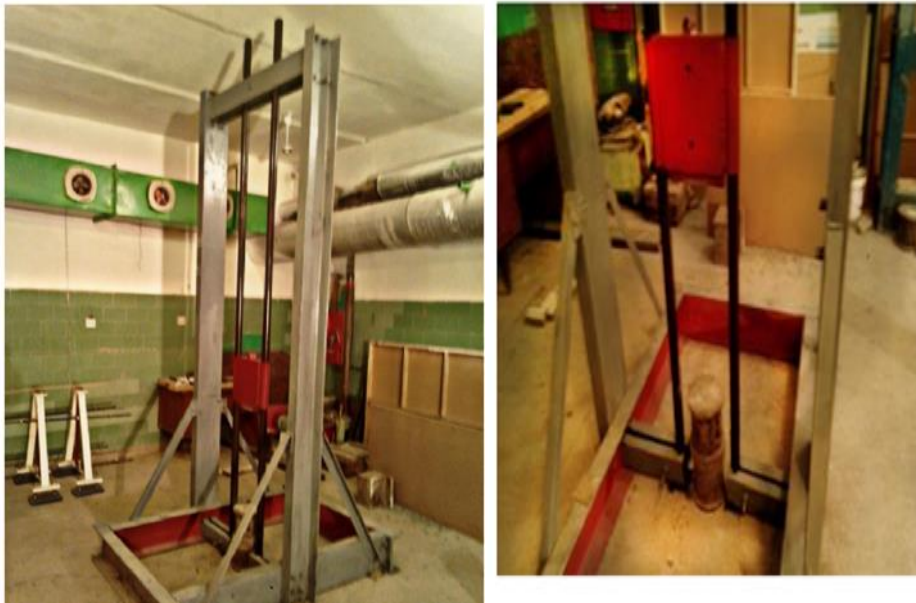
Рис. 7.3 – Загальний вигляд установки для визначення ударної міцності
