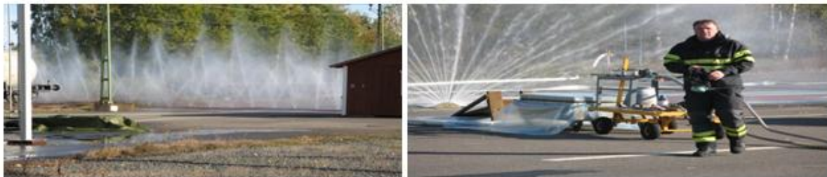
Рис. 2. Водяні завіси для осадження НХР
