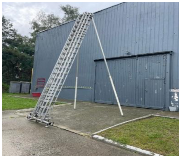
Рис. 2. Зовнішній вигляд розсувних пожежних драбин, які відповідають національному стандарту [2]
