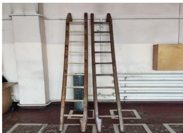
Рис. 7. Зовнішній вигляд драбин – палиць, які відповідають національному стандарту [2]
