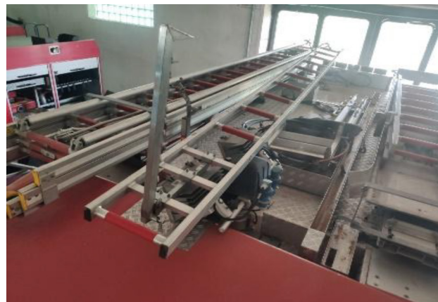
Рис. 3. Зовнішній вигляд штурмових пожежних драбин, які відповідають національному стандарту [2]
