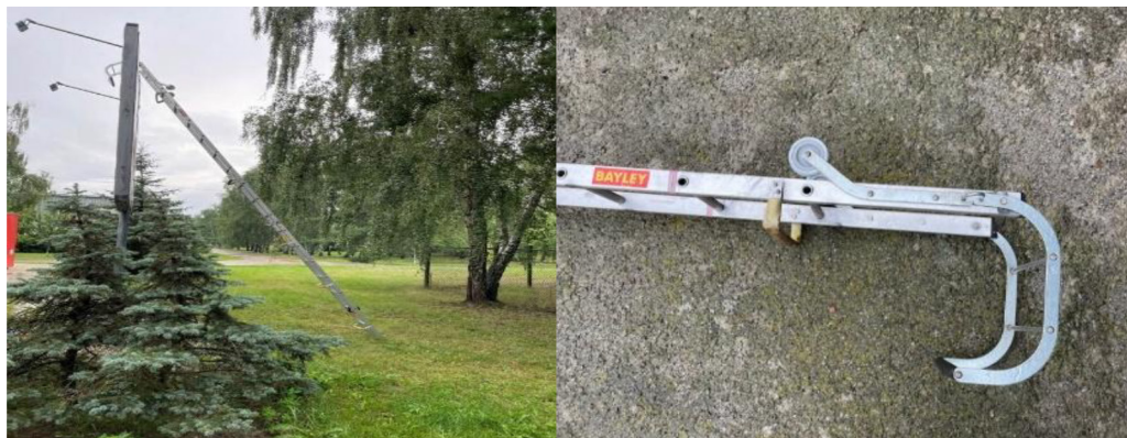
Рис. 5. Зовнішній вигляд пожежних драбин, які використовуються для робіт на дахах будівель, що відповідають національному стандарту [2]
