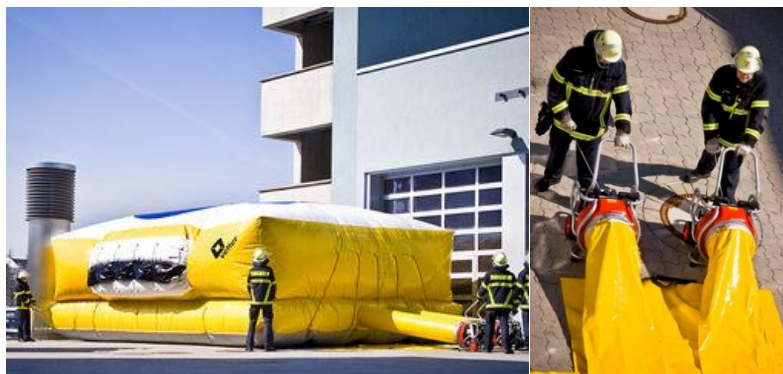
Рис. 2. Пневматична рятувальна подушка VETTER SP 60 вентиляторного типу.
