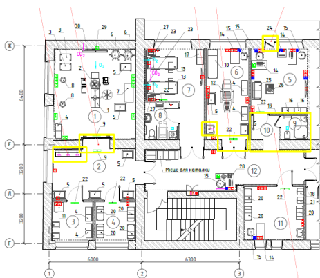
Рис. 1. План поверху та місце розташування датчиків, що вимірюють НЧП.
