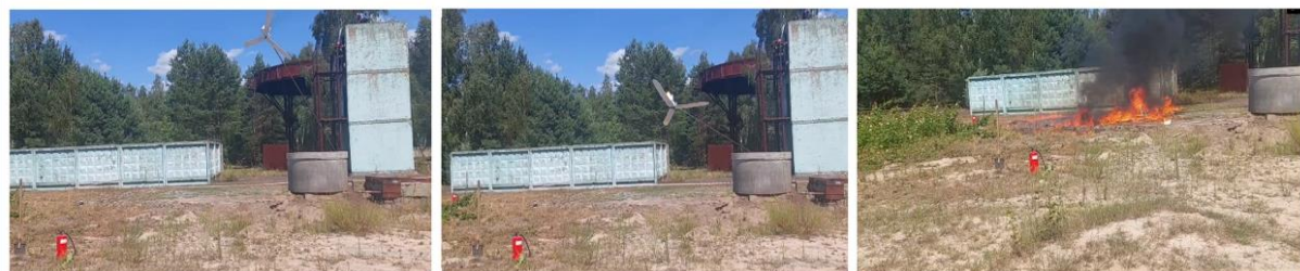
Рис. 3. Фото імітації падіння макету вітрової електроустановки під час вогневих досліджень
