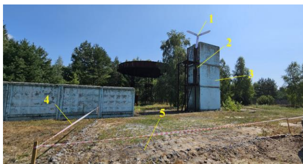
1- вітрова електроустановка; 2 – вежа яка тримає гондолу; 3 – допоміжна споруда операторів досліджень; 4 – межа вогневого майданчику; 5 – маркерна сітка для фіксації площі розливу оливи. Рис. 1. Зовнішній вигляд випробувального вогневого майданчику
