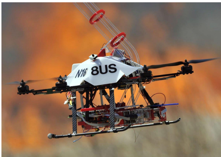
Рис. 1.7. Автономний пожежний квадрокоптер
