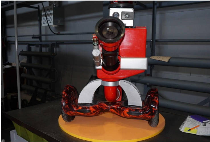
Рис. 1.19. Мобільна пожежна установка на базі сігвея
