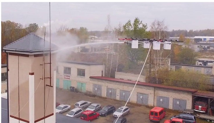
Рис. 1.6. Гасіння пожежі пожежним квадрокоптером
