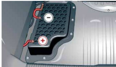
Рис. 8.22.1. Від'єднання батареї/батарей 12 В
