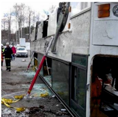
Рис. 10.4.1.2. Стабілізація автобуса гідравлічними циліндрами
