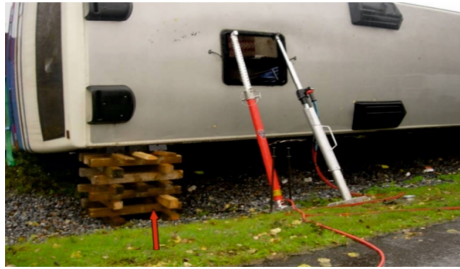
Рис. 10.3.5.5. Способи підйому автобуса
