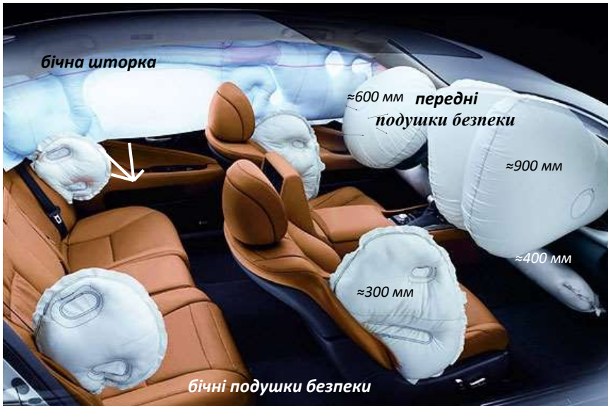
Рис 7.3.1. Розташування подушок безпеки в сучасних ТЗ
