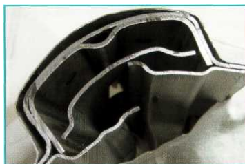
Рис 7.1.2. Поперечний переріз середньої стійки ТЗ 2002 року
