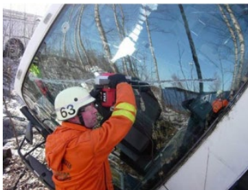
Рис. 10.2.3.3. Доступ через лобове скло
