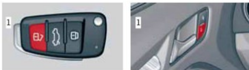
Рис. 8.18.1. Радіочастотного ключа, центральний замок в салоні
