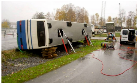
Рис. 10.3.5.6. Способи підйому автобуса
