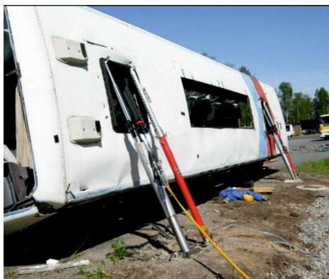
Рис. 10.3.5.4. Способи підйому автобуса
