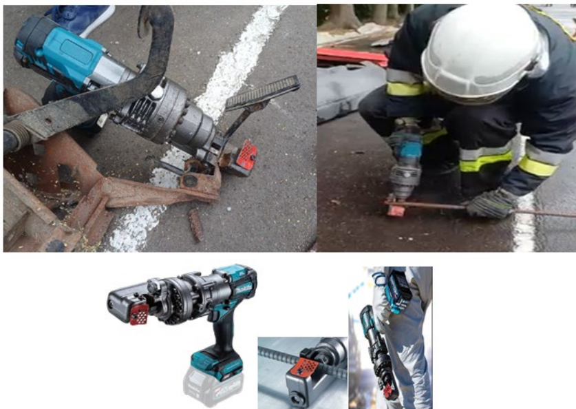
Рис.12.34. Акумуляторний різак сталевих прутів
