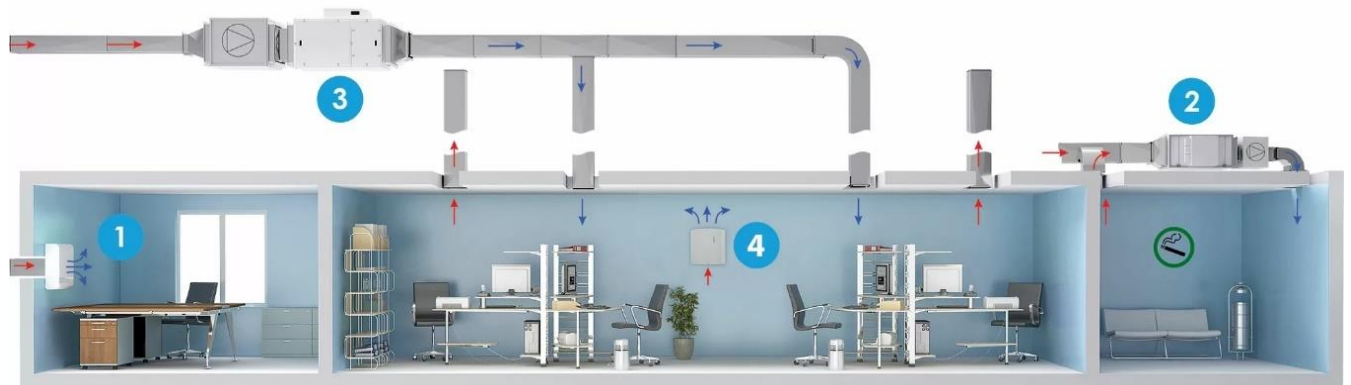
Рис. 2.9. Централізована установка кондиціонування
