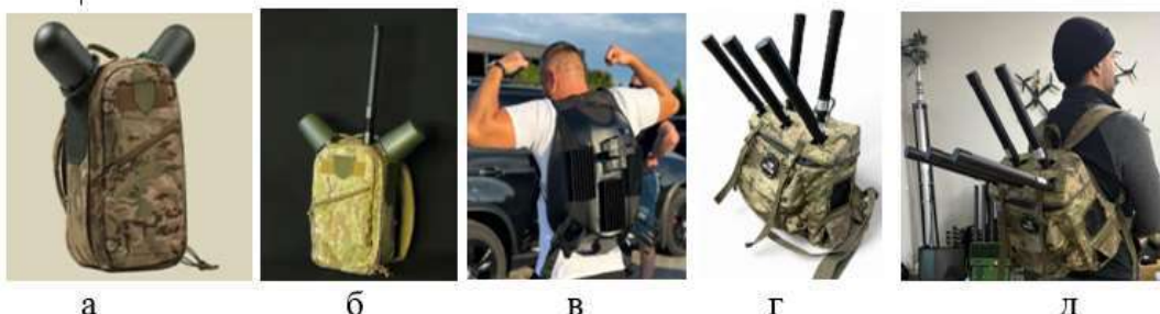
Рисунок 1. Купольний мобільний РЕБ Рюкзак "Backpack FPV 100W": а) 2 діап. (700-860/860-1020МГц), б) 3 діап. (700-860/860-1020/2400 МГц), в) 3 діап. (290-390; 613-717; 2397-2537 МГц), г, д) 5-діап. 250 МГц - 5.8 ГГц РЕБ-рюкзак WARMAX [2, 3].
