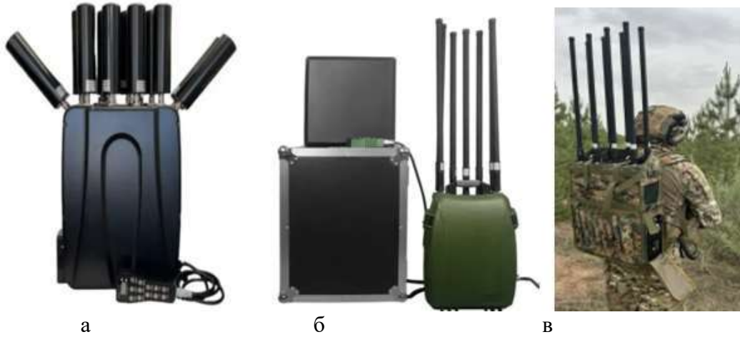
Рисунок 2. РЕБ-рюкзакі багатоканальні, широкодіапазонні: а) "Сагайдак PRO" (350, 400, 500, 600, 700, 800, 900, 1050, 1200, 1500, 2400, 5800) МГц; б) глушилка дронів, TX-BF08 Map pack FPV (5-8) діап. 433, 700, 850, 900, 940, 1000, 1080, 2400-2500), (5725-5850) МГц; військовий з носимою системою РЕБ.
