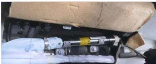
Рис 7.3.6. Вмонтовані балони зі стисненим газом
