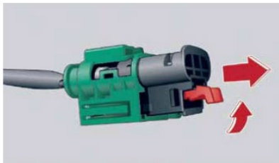
Рис. 8.20.5. Штекер аварійного вимкнення високовольтної системи
