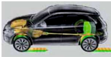
Рис. 8.3.4. Рух електродвигуна і двигуна внутрішнього згоряння
