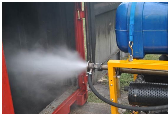
Рис. 1 – Отримання ТРВ за допомогою установки пожежогасіння періодично-імпульсної дії
