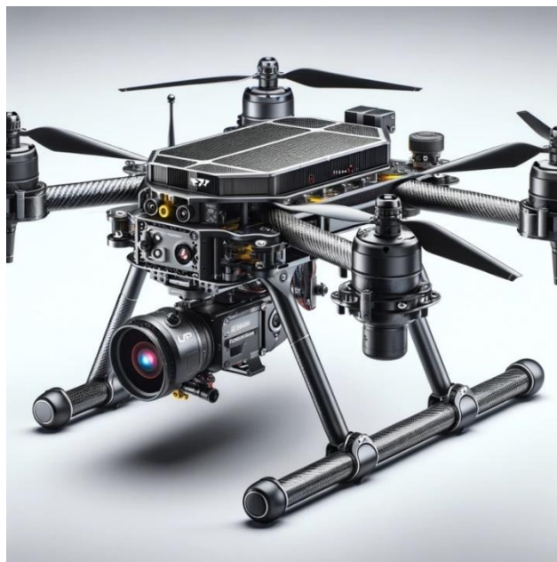
Рис.1 – Проєкт БПЛА оснащений тепловізійним сенсором FLIR, лідаром Velodyne, мультиспектральним сенсором VicaSense, сенсором якості повітря Aeroqual на карбоново-полімерній рамі посиленій вуглецевими волокнами
