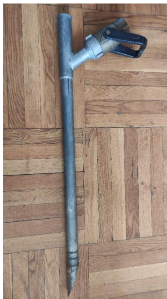
Рис. 2 – Пожежний пробивний ствол для гасіння автомобілів з наявними електричними чи гібридними елементами живлення
