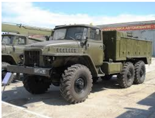
Рис. 4.10. Авторозливна станція АРС-15
