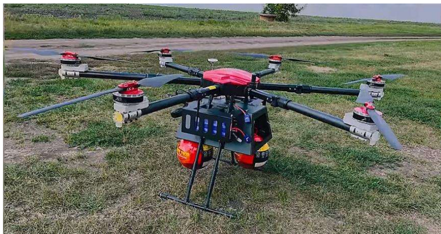
Рис. 1 – Гексакоптер із засобами гасіння
