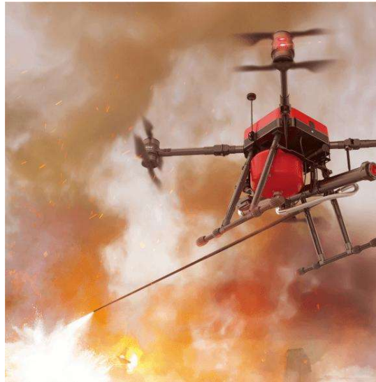
Рис. 2 – БпЛА мультироторного типу із телескопічним пожежним стволом
