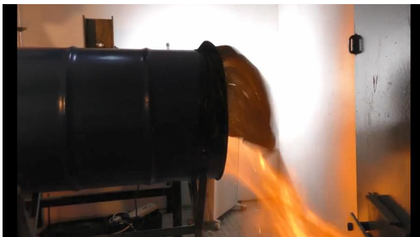
Рисунок 2 – Випробувальне устаткування для випробування аерозольних розпилювачів на займистість у замкнутому просторі в процесі експлуатації
