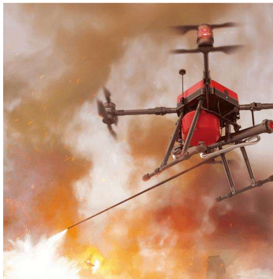
Рис. 2 – БпЛА мультироторного типу із телескопічним пожежним стволом
