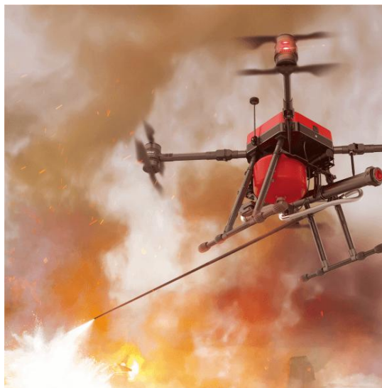
Рис. 2 – БпЛА мультироторного типу із телескопічним пожежним стволом
