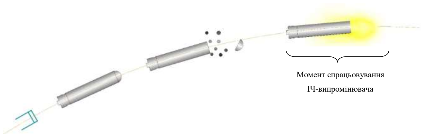
Рис. 1.4. Загальний вигляд типових піротехнічних ІЧ-випромінювачів та схема їх дії [36, 108, 187].
