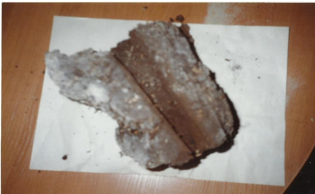
Рис. 4.3. Моноліт торфу зі щілиною, що заповнена піском.
