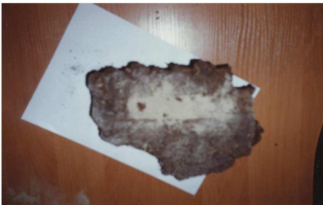
Рис. 4.3. Моноліт торфу зі щілиною, що заповнена піском.
