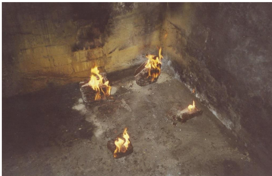
Рис. 4.1. Горіння зразків торфу в газодимокамері.
