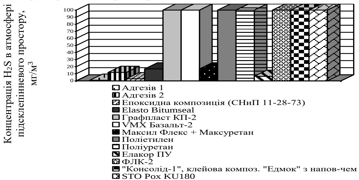
Рис. 10. Концентрація H_2S в атмосфері підсклепінного простору залізобетонних каналізаційних трубопроводів, при якій досліджуване покриття надійне більш 10 років
