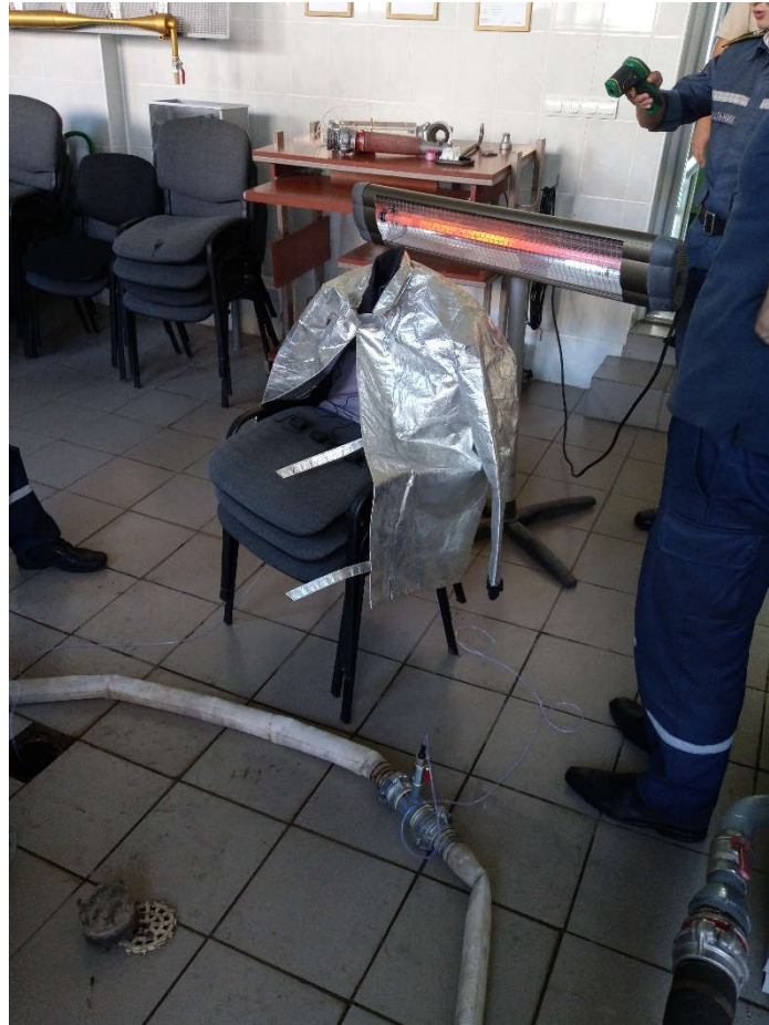
Рисунок 5.6 – Лабораторна установка для визначення ефективності проточної системи охолодження теплозахисної куртки
