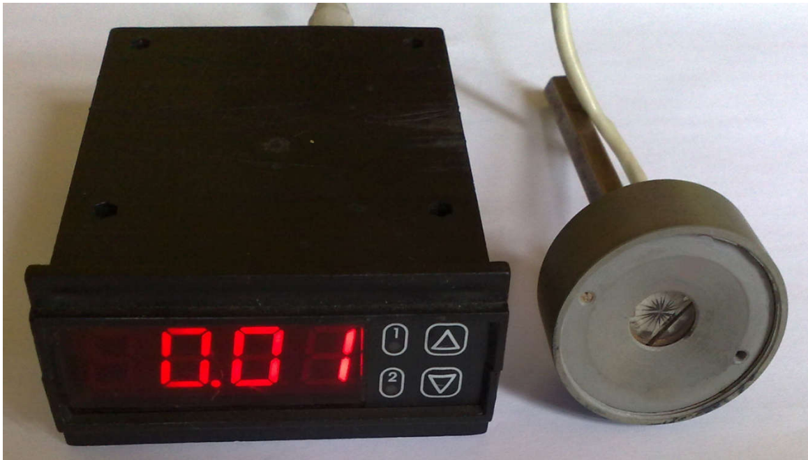
Рисунок 5.22 – Вимірювач тепловго потоку типу ВТП-01, до складу якого входить пірометричний перетворювач із з'єднувальним кабелем та цифровий прилад
