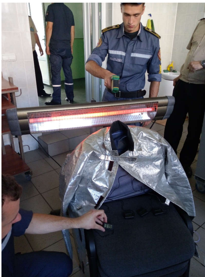
Рисунок 5.7 – Вимірювання температури у підкостюмному просторі за умови використання проточної системи охолодження теплозахисної куртки
