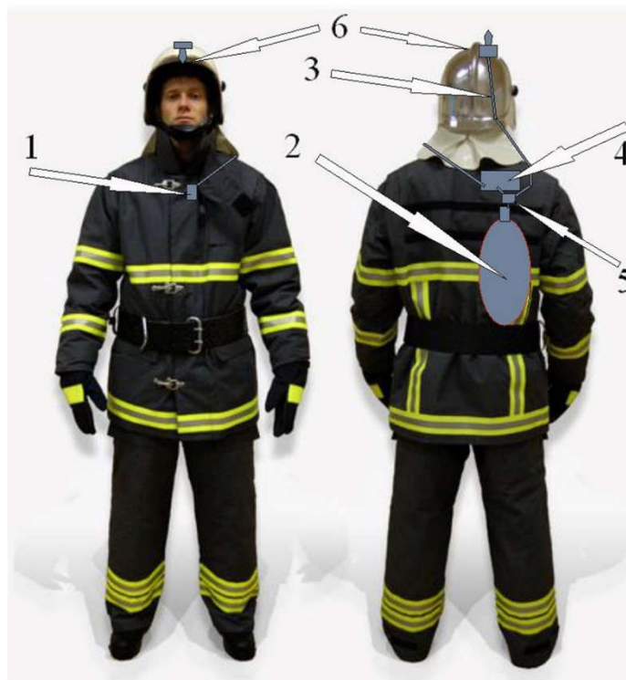
Рисунок 6.2 - Оснащення рятувальника в захисному одязі автоматичним автономним теплозахисним пристроєм. Вид спереду та ззаду: 1 – датчик температури; 2 – резервуар; 3 – трубопроводи; 4 – блок управління; 5 – електромагнітний клапан; 6 – розпилювач.
