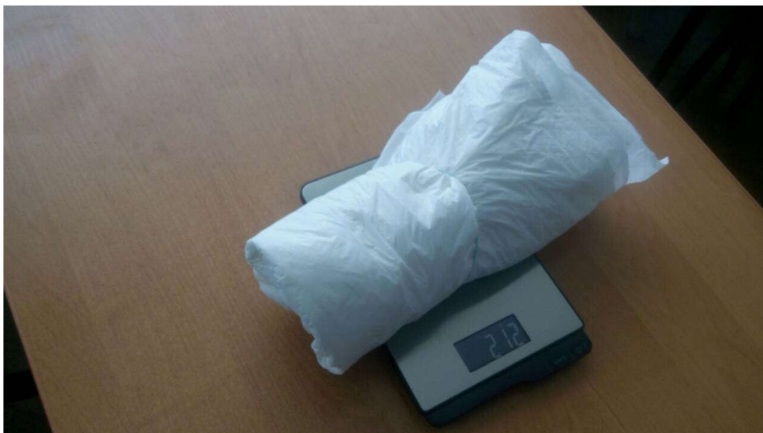
Рисунок 3.8 – Зважування вологопоглинаючої жилетки після проведення випробувань.
