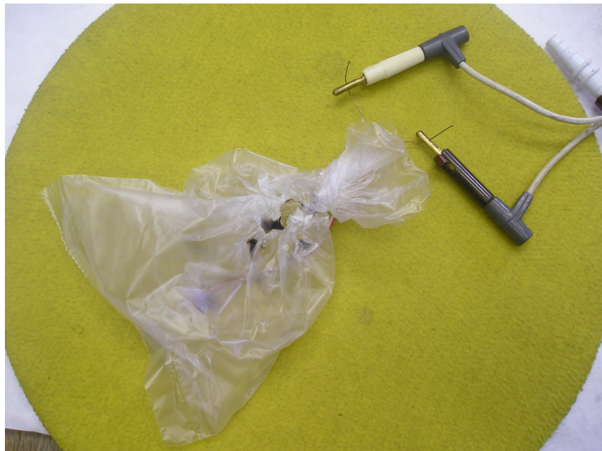
Рис. 3.11. Результат деформації вибухової камери із повітрям при ініціюванні займання суміші електродетонатором.
