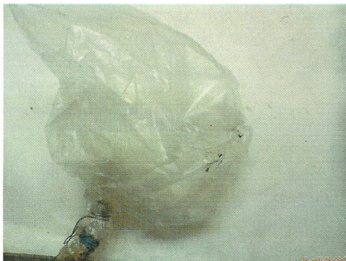
Один из полиэтиленовых мешков, в котором не произошло инициирование.
