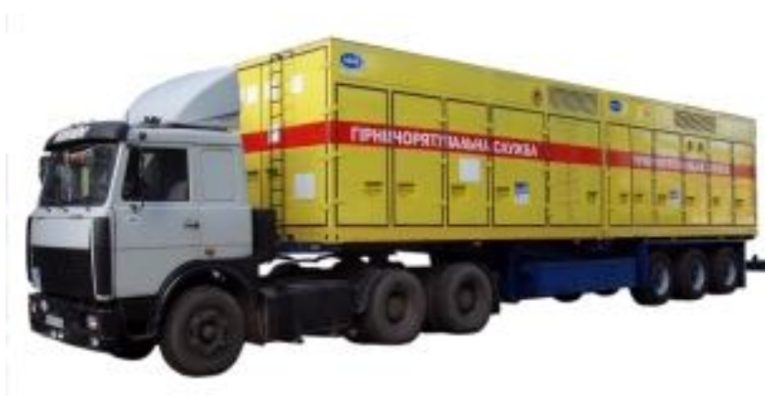
Рис.1.8 – Азотно-компресорна станція АМГП-15/0,7С
