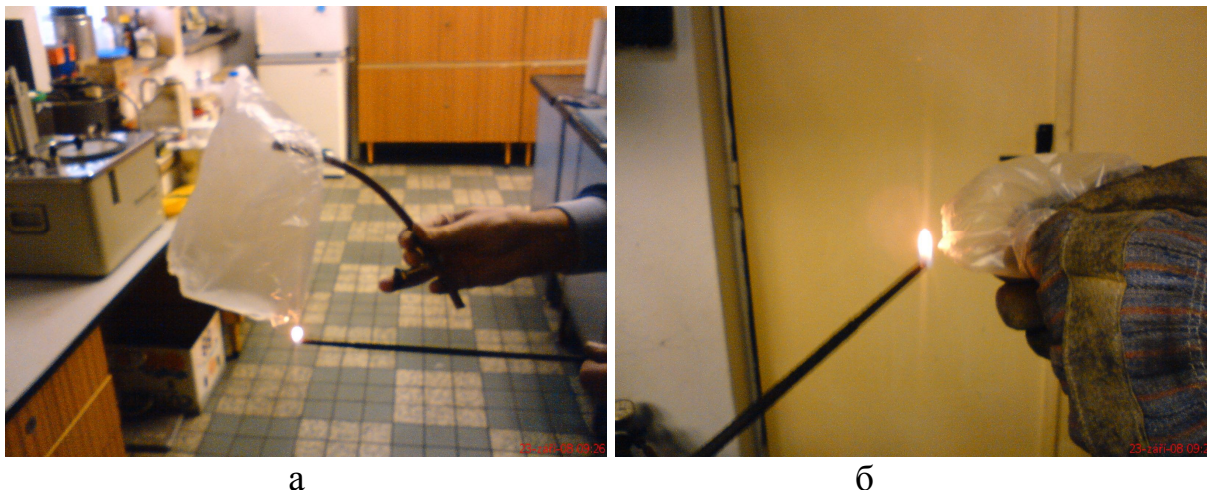
Рис. 3.6. Ініціювання горіння суміші від джерела відкритого полум'я: а – загальний вигляд експерименту; б – фрагмент випробувань
