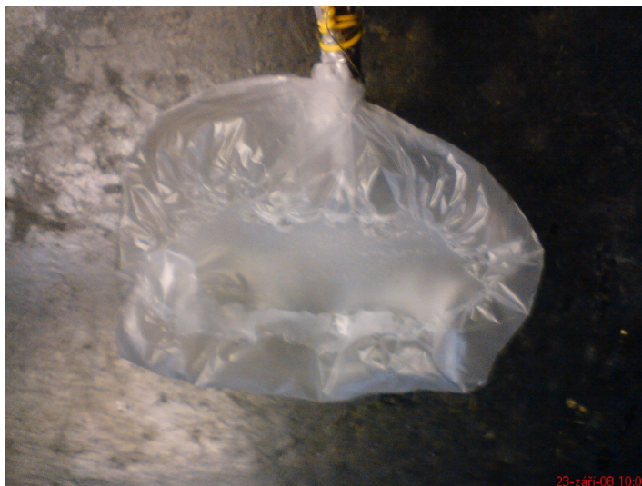
Рис. 3.8. Відсутність займання газової суміші.
