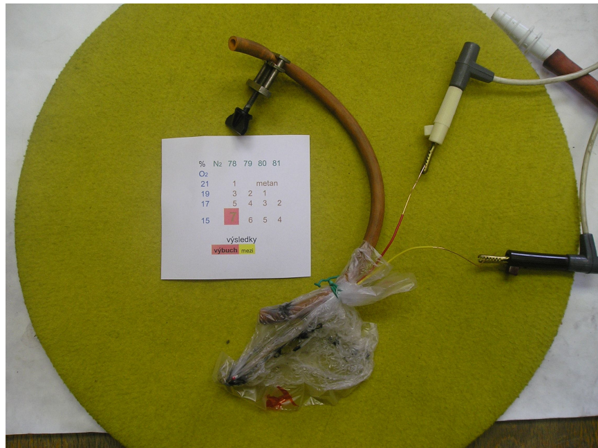
Рис. 3.10. Результат деформації вибухової камери, у якій було 7% метану, 15% кисню і 78% азоту, при ініціюванні займання суміші електродетонатором.
