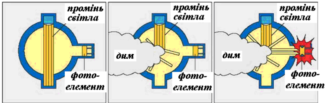
Рис. 4.12. Схема детекторного сповісвача диму
