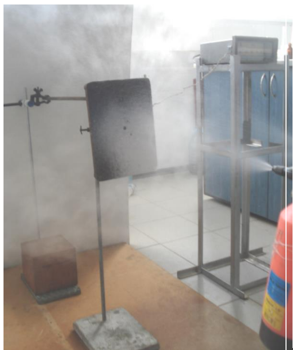
Рис. 8. Лабораторна установка для дослідження охолоджуючої дії ГУС
