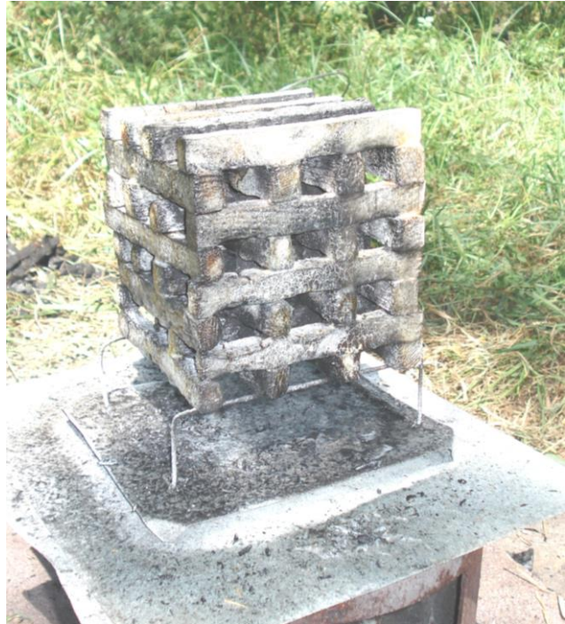
Рис.13. Лабораторний модельний осередок пожежі, який погашено ГУС (\text{NH}_4)_2\text{SO}_4 + \text{NH}_4\text{H}_2\text{PO}_4 + \text{Na}_2\text{O} \cdot 2,7\text{SiO}_2
