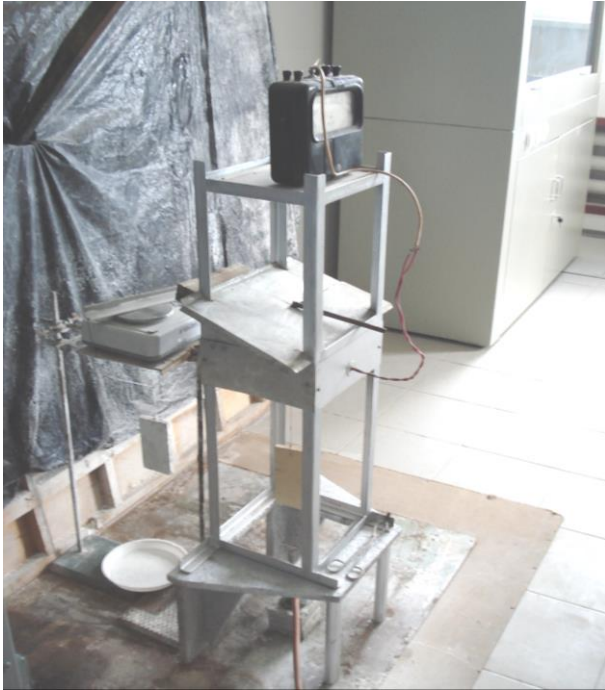
Рис. 14. Лабораторна установка для дослідження повторного займання матеріалів, які оброблено ГУС
