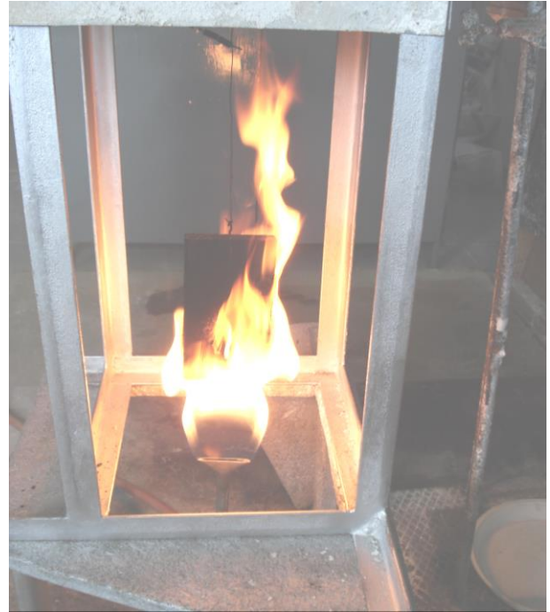
Рис. 15. Камера для вогневих випробувань установки для дослідження повторного займання
