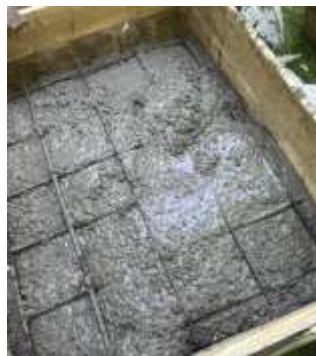
Рисунок 3.11. Фото виготовлення фрагменту несучої залізобетонної стіни для виконання дослідження з їхнього нагрівання
