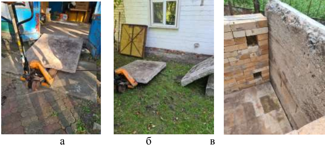
Рисунок 3.10. Малогабаритні фрагменти несучих залізобетонних стін, виготовлені заздалегідь до проведення експериментів: а – транспортування фрагментів; б – 2 фрагменти, підготовлені до виконання експериментів, 1 уже встановлений у камері вогневої печі; в – фрагмент стіни установлений до початку випробування, на місці експерименту
