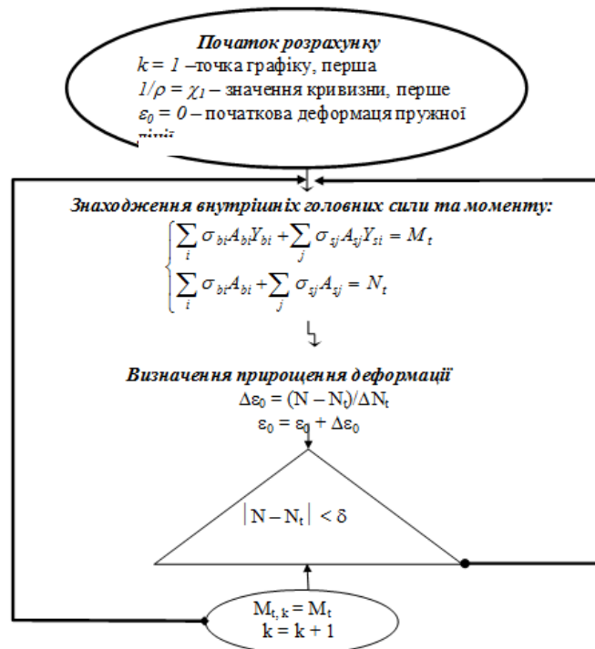
Рисунок 4.5. Блок-схема побудови графіку головного моменту у перерізі стіни
