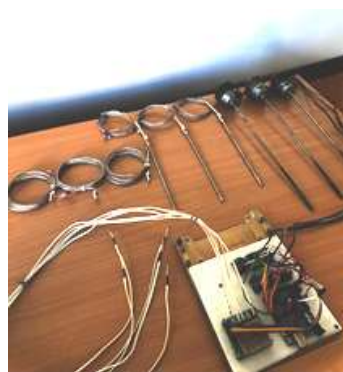
Рисунок 3.9. Спеціальний засіб зчитування інформації – блок комбінованого обчислення температур
