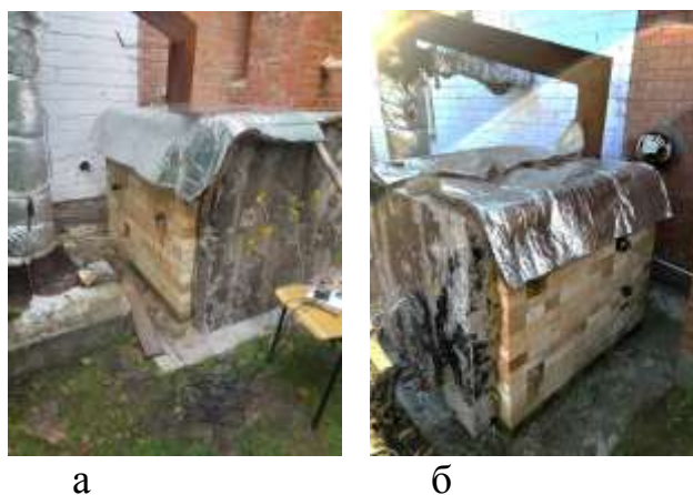
Рисунок 3.15. Розташування засобів вимірювальних приладів під час виконання експерименту з нагрівання несучої залізобетонної стіни: а – ліва сторона п-подібної камери вогневої установки, б – права сторона, де розташована одна термопара
