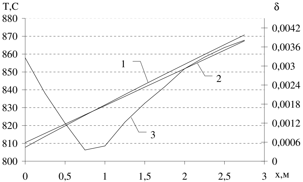
Рис. 2.22. Зависимость температуры сухой стенки горящего резервуара РВС-5000 с бензином от высоты над уровнем нефтепродукта: 1 – при численном решении; 2 – при решении с помощью приближенной зависимости; 3 – погрешность при переходе от численного метода к приближенной зависимости
