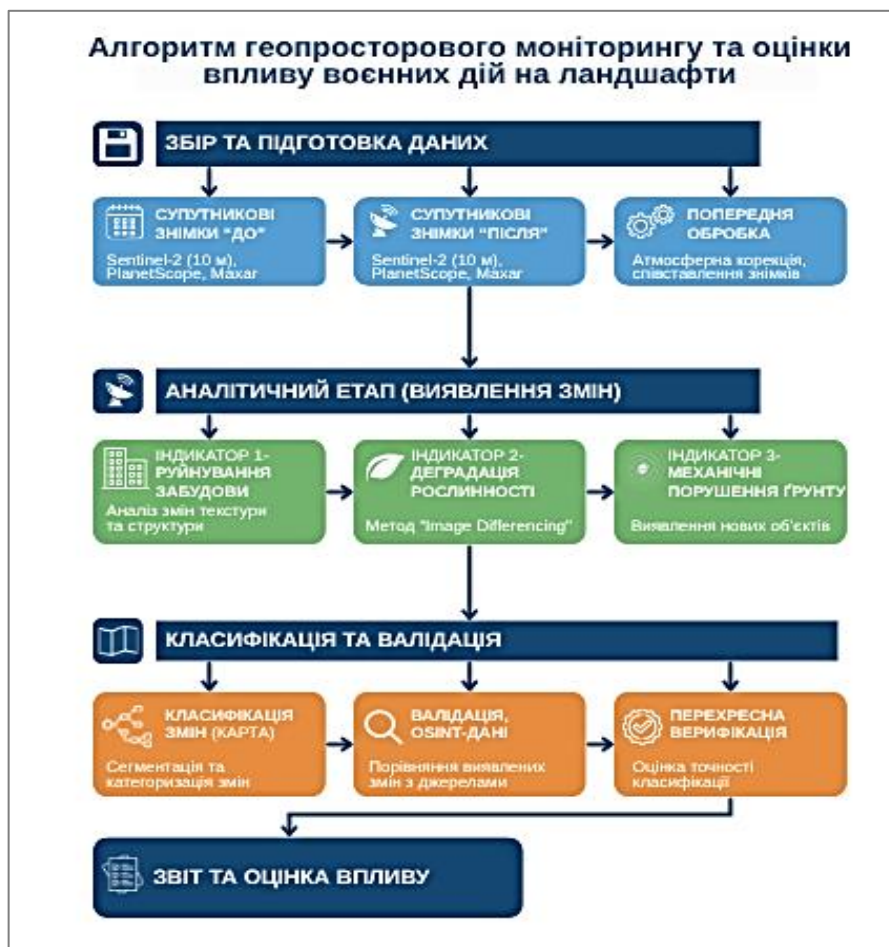
Рисунок 1 – Схема алгоритму геопросторового моніторингу та оцінки впливу воєнних дій на ландшафти
