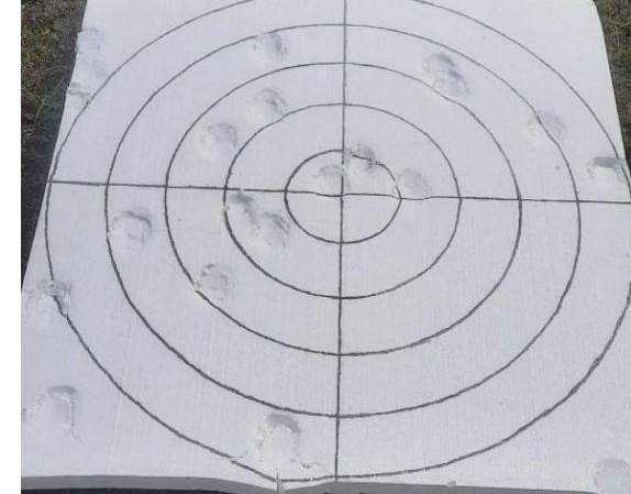
Рис. 3.9. Експериментальне дослідження купності дискретної подачі вогнегасних речовин, 9 метрів до мішені (пробне випробування)
