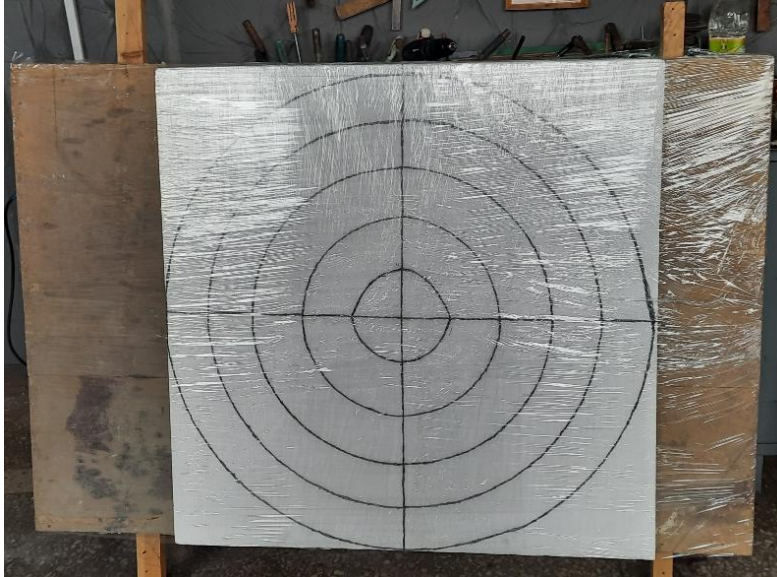
Рис. 3.8. Мішень із пінопласту для експериментальних досліджень прикріплена до деревного щита за допомогою стрічки поліетиленової
