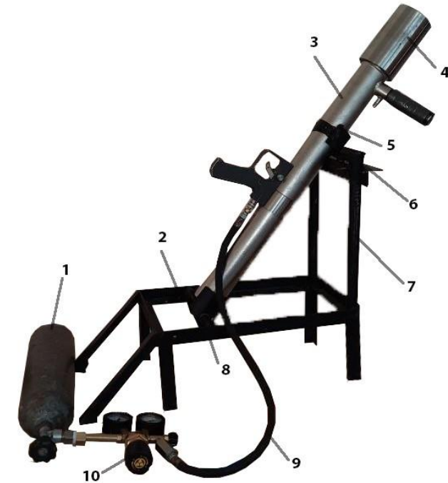
Рис. 2.8. Дослідна установка для дискретної подачі вогнегасних речовин у контейнері. Елементи: 1. Балон із стисненим повітрям. 2. Лафет для фіксування та зміни кута нахилу пневматичної гармати. 3. Ствол пневматичної гармати (імпульсної дії). 4. Насадок для контейнерів із вогнегасною речовиною. 5. Скоба фіксації ствола. 6. Регулююча планка по вертикалі кут нахилу ствола. 7. Вертикальна опора, по якій переміщається регулююча планка. 8. Упорна регулююча основа зміни кута нахилу ствола по горизонталі. 9. Повітряний шланг. 10. Редуктор регулювання тиску в повітряній камері ствола.
