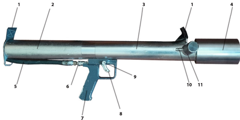
Рис. 2.4. Фото дослідного зразка ствола дискретної подачі вогнегасних речовин: 1. Ремінь для перенесення ствола. 2. Камера для стиснутого повітря. 3. Камера для рідини. 4. Насадок для контейнера з вогнегасною речовиною. 5. Повітряний шланг. 6. Штуцер із «системою швидкого з'єднання». 7. Рукоятка для тримання. 8. Спусковий курок. 9. Запобіжник від помилкового натискання на гачок. 10. Штуцер для підводу рідини. 11. Рукоять обертаюча відкриття клапану для заповнення рідиною
