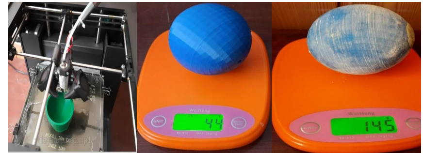
Рис. 3.22. а) 3D друк контейнера для доставки ВР; б) пустий контейнер для доставки ВР; в) з вогнегасним порошком для доставки в осередок пожежі
