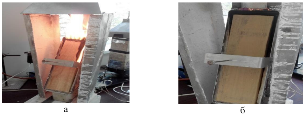
Рис. 1. Вигляд зразків під час випробувань: а – незахищеної деревини; б – захищеної покриттям.
