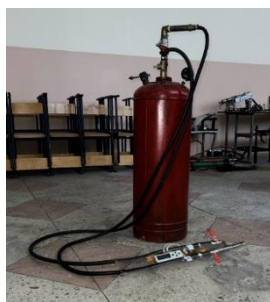
Рис. 1. Лабораторний зразок системи генерування та подавання компресійної піни наведено.
