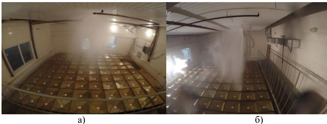
Рис. 1. Загальний вид форми розпилювання води: а) – у горизонтальній та б) – у вертикальній площинах за його горизонтальної орієнтації у просторі.
