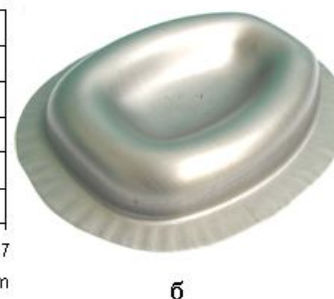
Рис. 3. Распределение утонений \epsilon_3 вдоль среднего сечения (а) и заготовка (б), отштампованная по предварительной матрице
