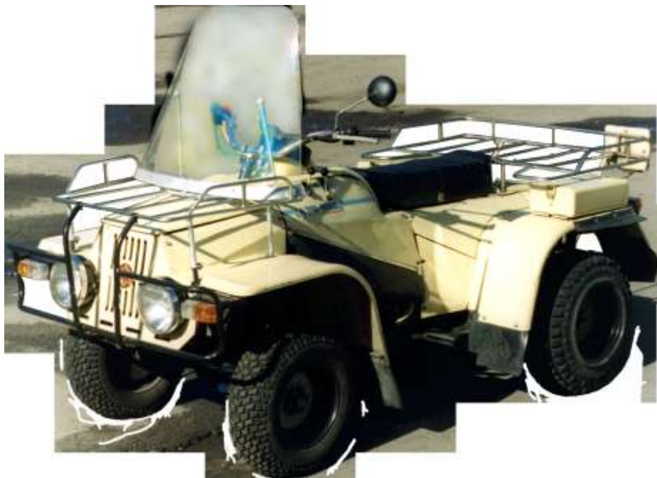
Рисунок 1 – Чотириколісний мотоцикл ЗІМ-800Д з дизелем 2ДТМ
