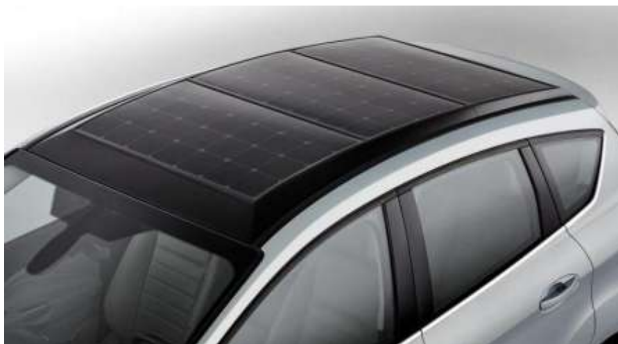
Рисунок 4 – Сонячні панелі на корпусі електромобіля
