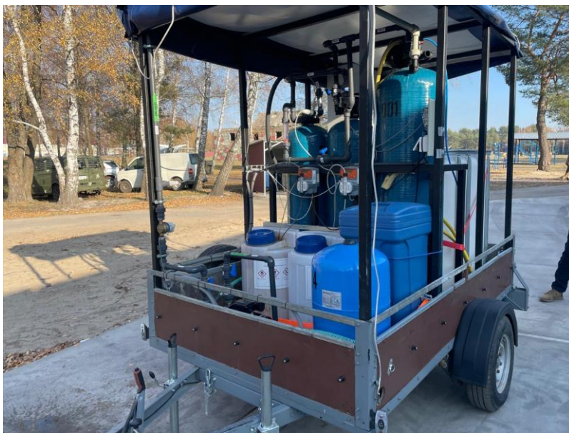
Рисунок 1 – Мобільна станція фільтрування питної води, обладнана на базі автомобільного причепа
