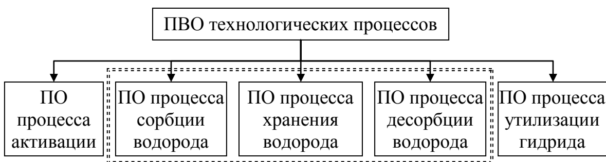
Рис. 1.4. Пожарная опасность технологических процессов СХП водорода на основе ИМС
