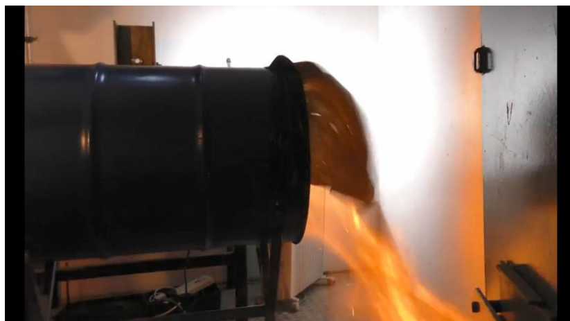
Рисунок 2 – Випробувальне устаткування для випробування аерозольних розпилювачів на займистість у замкнутому просторі в процесі експлуатації
