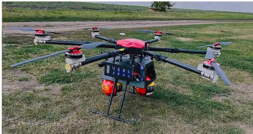
Рис. 1 – Гексакоптер із засобами гасіння
