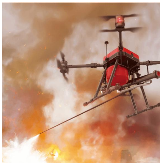
Рис. 2 – БпЛА мультироторного типу із телескопічним пожежним стволом
