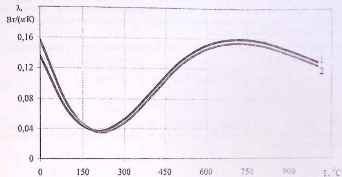
Рисунок 2 – Зависимости эффективных коэффициентов теплопроводности трехслойных перегородок от температуры, полученных при решении двойной ОЗТ с толщиной теплоизоляционного слоя в перегородках 60 и 80 мм. Кривая 1 – рассчитана при точных значениях температур, 2 – при возмущенных значениях температур до 10%
