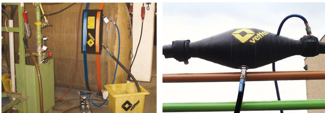
Рисунок 4.13. – Системи перекачування НХР із пошкоджених ємностей
