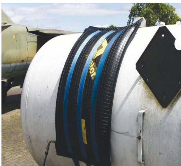
Рисунок 4.11. – Закривання отворів на резервуарах за допомогою бандажів
