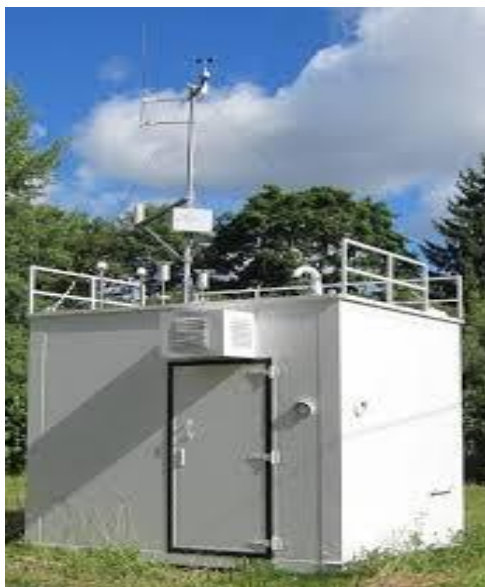
Рисунок 4.1. – Стаціонарний комплекс метеорологічного контролю та контролю хімічного стану повітря
