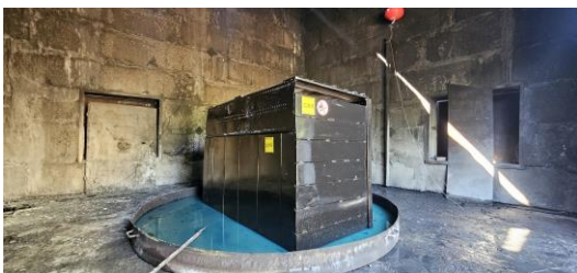
Рисунок 1 – Натурний макет дизельного електрогенератора
