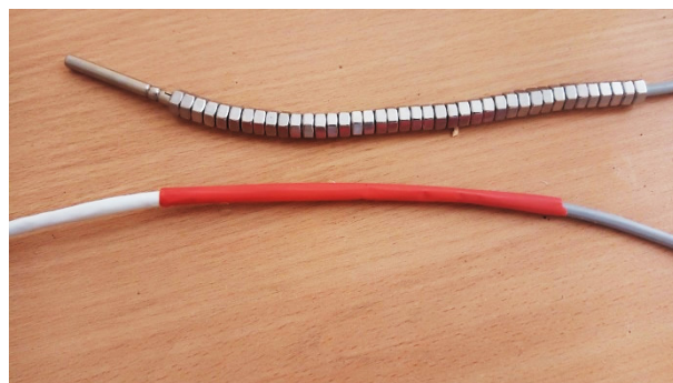
Рисунок 4 – Термоперетворювач опору з грузилом поєднаний до проводу 4 \times 2 \times 0,51 (SF/UTP-cat.5E)
