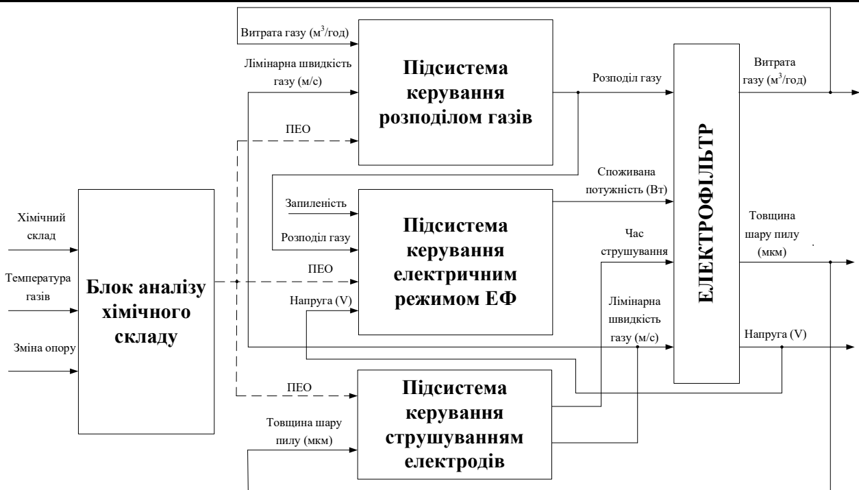
Рисунок 2. Структурна схема установки очищення газу електрофільтрами
