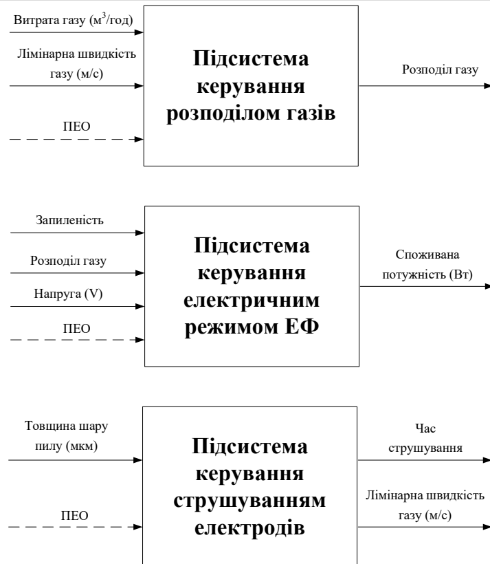
Рисунок 1. Підсистеми керування очищення газу у електрофільтрі
