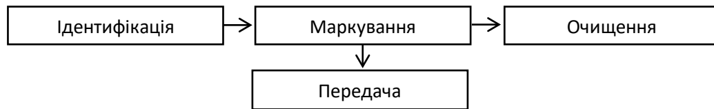
Блок-схема 1. Загальний алгоритм розмінування
