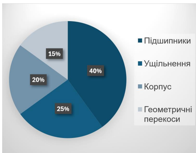
Рис. 2. Причини відмов традиційних роликів
