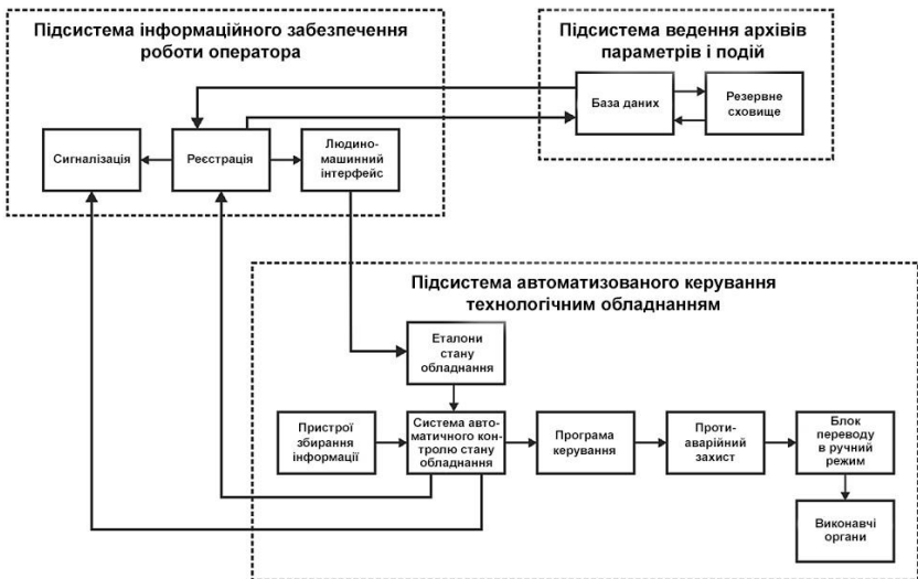
Рис. 1. Схема процесу повної автоматизації за принципом «від печі до сертифіката»
