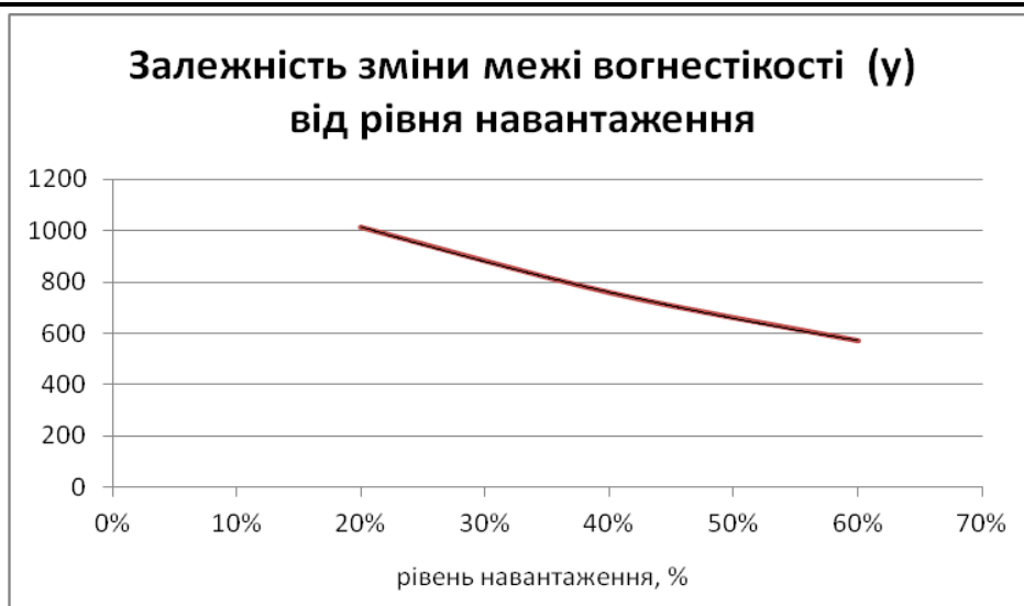
Рис. 10. Графік залежності зміни межі вогнестійкості досліджуваної сталеві колони від рівня прикладеного механічного навантаження.
