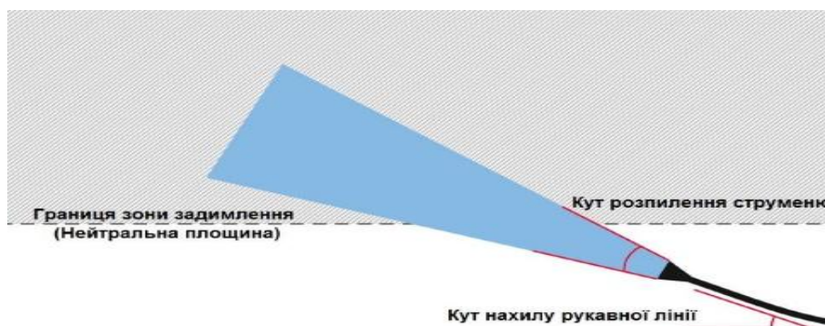
Рис. 1. Механізм утворення водяної пастки (інверсія шару продуктів згоряння)
