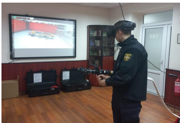
Рис. 1. Симулятор віртуальної реальності FLAIM Trainer T3
