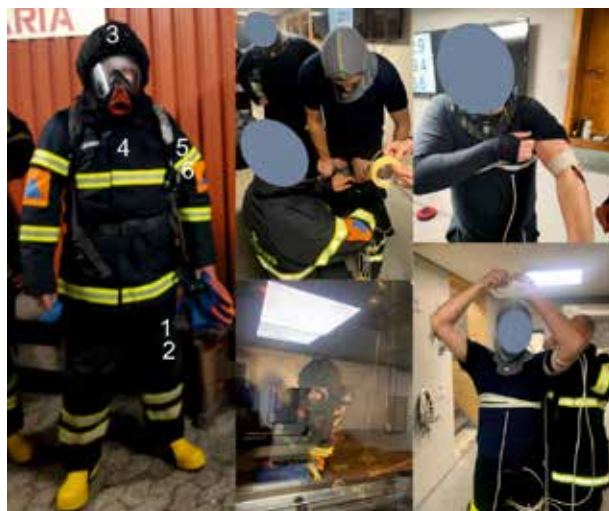
Рис. 3. Схема та порядок розміщення термодатчиків на газодимозахиснику для визначення температури підкостюмного простору захисного одягу: 1, 2 – стегнова частина ноги (голе тіло та підкостюмний простір відповідно); 3 – голова (під підшоломником); 4 – груди (підкостюмний простір); 5, 6 – передпліччя (голе тіло та підкостюмний простір відповідно)
