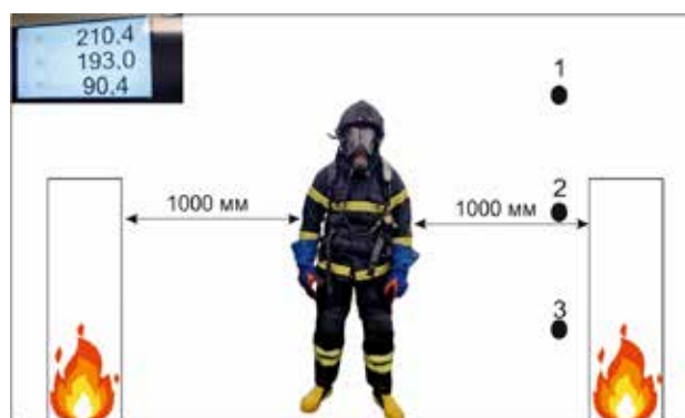
Рис. 2. Схема вогневого випробування для визначення показників підкостюмного простору захисного одягу пожежного: 1, 2, 3 – термопари на висоті 180, 120, 60 см відповідно
