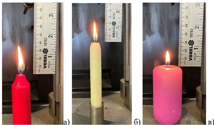
Рисунок 1 – Зовнішній вигляд процедури вимірювання свічок під час проведення експериментальних досліджень: а – вимірювання висоти полум'я факелу свічки діаметром 25 мм; б – вимірювання висоти полум'я факелу свічки діаметром 20 мм; в – вимірювання висоти полум'я факелу свічки діаметром 40 мм
