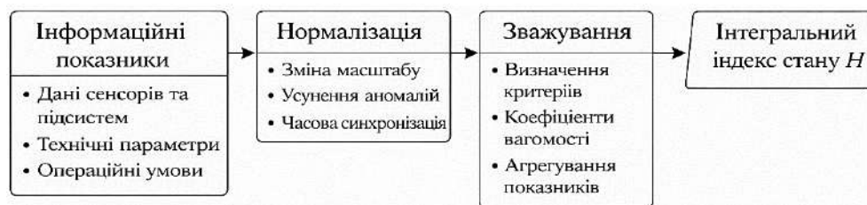
Рис. 1. Узагальнена схема аналітичної оцінки технічного стану
