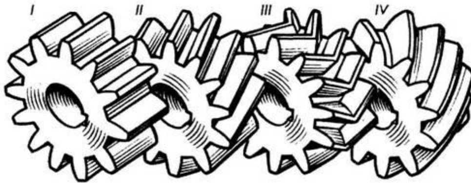
Рис. 24.1.2 – Форма зубців: I – прямі, II – косі, III – шевронні, IV – з криволінійними зубцями.
